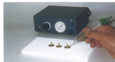
▲リトルトーチによる銀ろう加熱作業 ▲ディスペンサによる銀ろう供給
